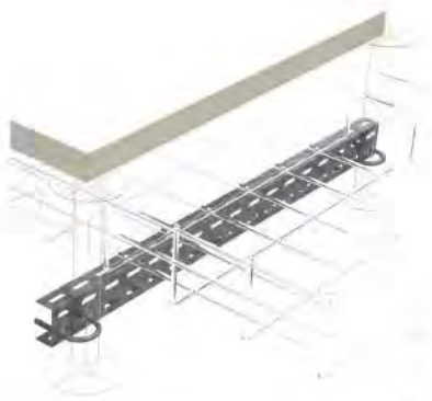
Suporte em estrutura de piso elevado
